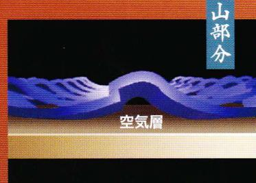
瓦裏の空気層により通気性と断熱性が生まれ、屋根と家屋を健全に保ちます。
